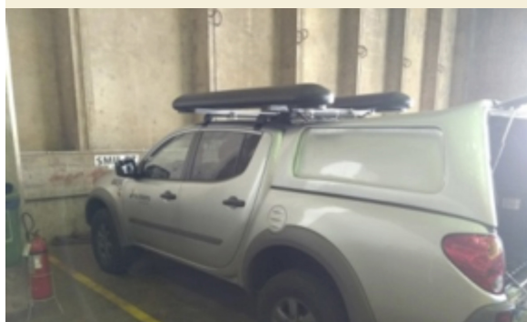
Plataforma móvel instalada em veículo. ►
