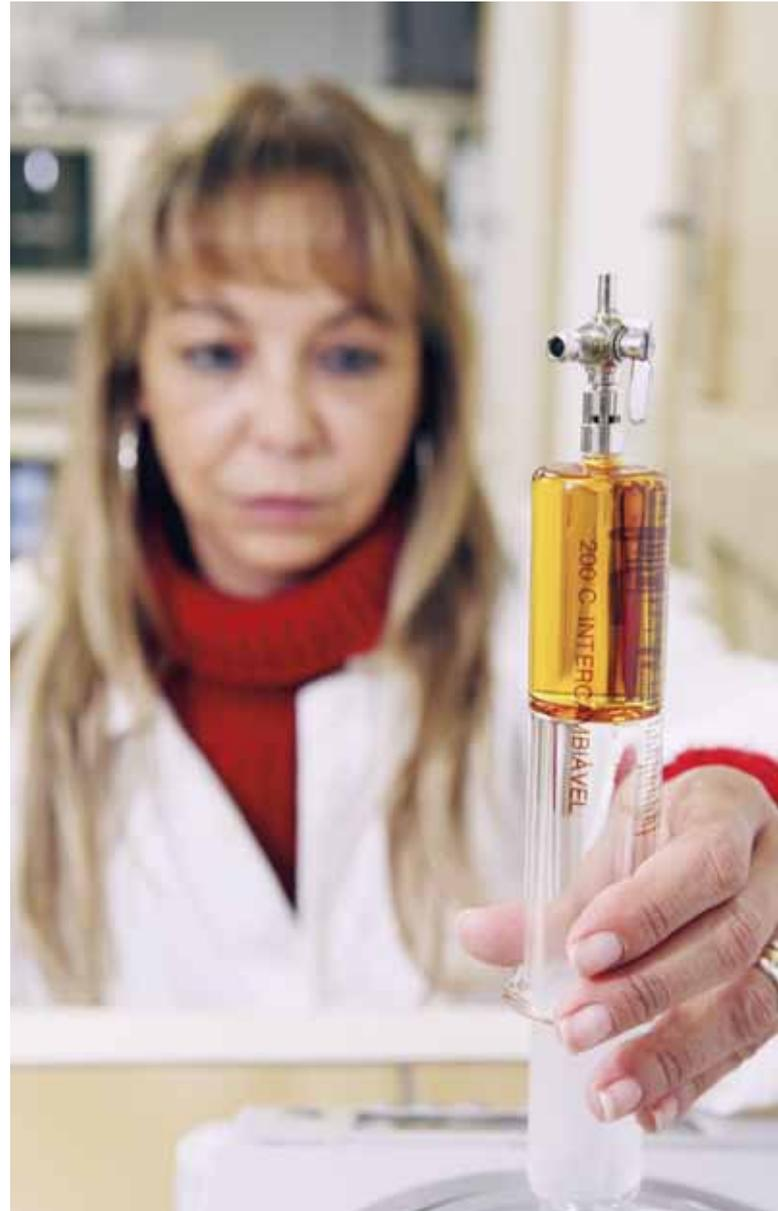
Para ser reaproveitado, o óleo é coletado por uma empresa especializada e passa por um processo de filtragem absoluta, sendo posteriormente readitivado. Esse processo pode ser repetido inúmeras vezes, o que evita a extração de recursos não renováveis e reduz os custos da empresa.
