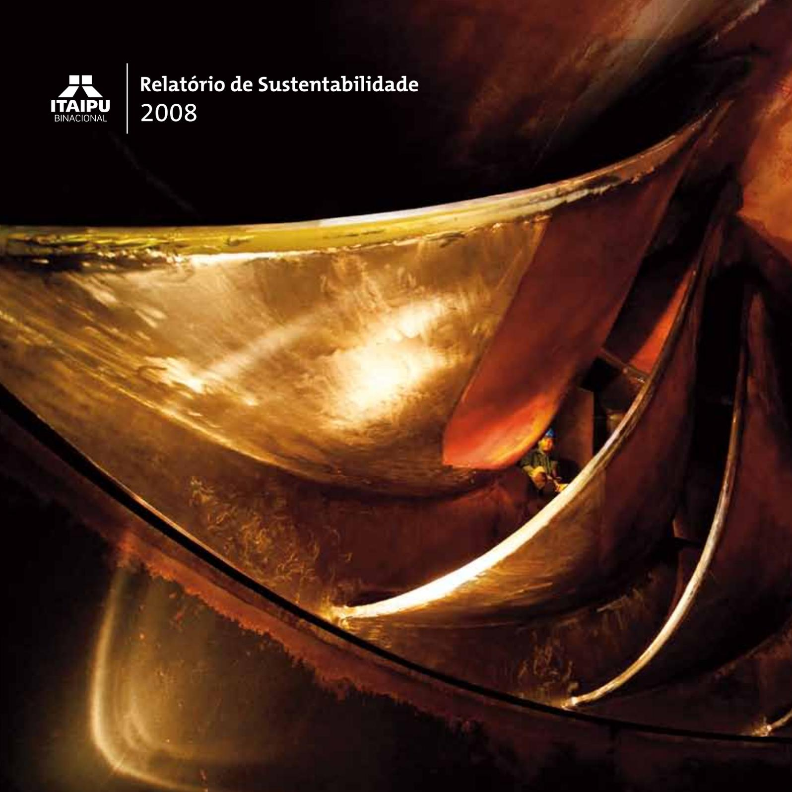
O empregado Jezuino Fernandes Oliveira executa manutenção na roda da turbina de uma das 20 unidades geradoras da usina de Itaipu. Cada roda pesa 300 toneladas.
