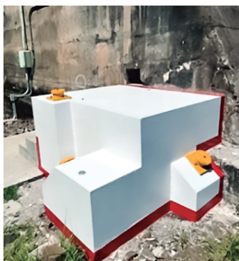
Bloco de extensômetros
