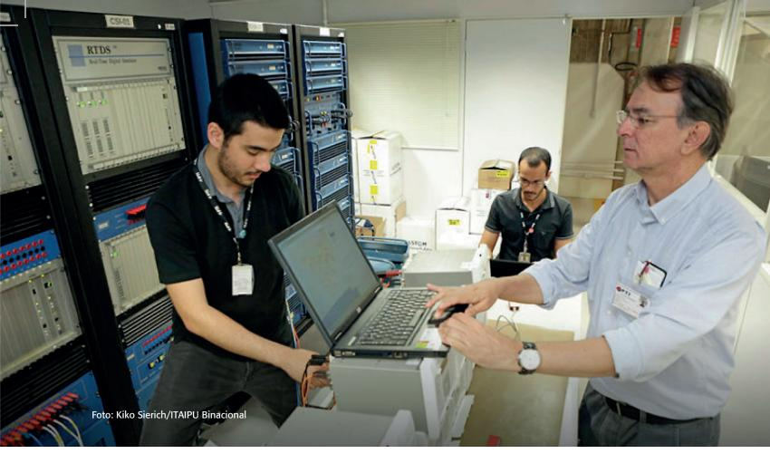
O Laboratório de Automação e Simulação de Sistemas Elétricos (Lasse) permite testes e verificação do desempenho dinâmico dos equipamentos, e sistemas associados à geração, transmissão e distribuição de eletricidade. Uma missão importante do Lasse é levar autossuficiência tecnológica à Itaipu Binacional. O Lasse também apoia o plano de atualização tecnológica da usina através de projetos de pesquisa, desenvolvimento e inovação.
