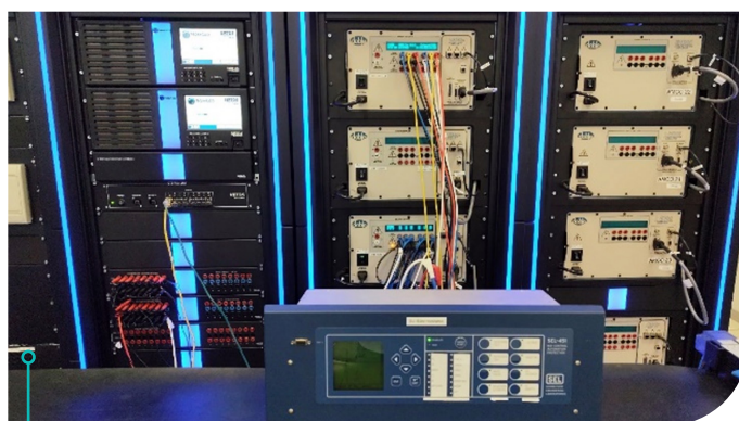
Implementação em bancada da função PPS
