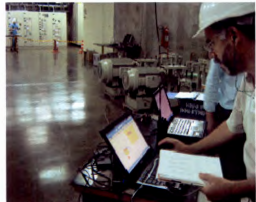
Ensaio do sistema de medição de entreferro, realizado pela SM.DT, com a supervisão e responsabilidade do CEITAIPU/Voith.
